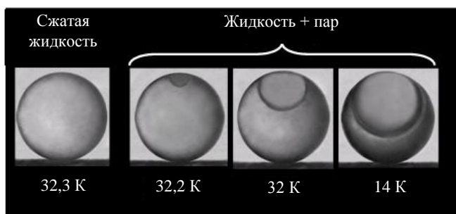
Рис. 6. СН-оболочка ( \varnothing 994 мкм) заполнена H_2 до 765 атм при 300 К, затем охлаждена до 14 К. Последующий нагрев производился до 32,3 К
